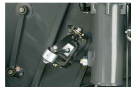
Het volledig automatische 3D-reinigingssysteem combineert hydrauliek en mechanica en werkt volledig zonder elektronische sensoren.
